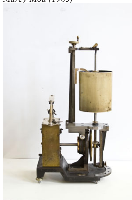
Figura 3 Kimógrafo de Baltzer con Polígrafo Inscriptor de Marey-Mod (1903) 10
