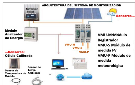
Figura 3. Arquitectura del Sistema de monitorización para el registro, almacenamiento y transferencia de datos del sistema fotovoltaico interconectado a la red eléctrica (SFVCR) del CERT.
