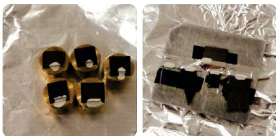
Figura 6. Muestras para realizar el análisis en el SEM (Izquierda) y EDS (Derecha)
