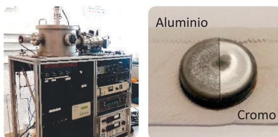
Figura 3: a) Equipo de erosión catódica y b) blanco tipo mosaico binario de cromo y aluminio
