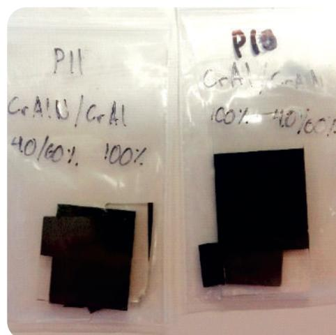
Figura 5. Sustratos de vidrio con depósitos de bicapas CrAlN/CrAl
