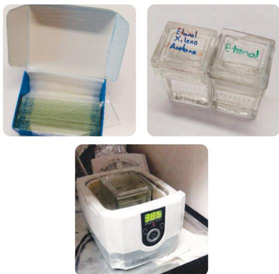
Figura 2: Componentes para limpieza de sustratos, a) sustratos de vidrio, b) reactivos químicos y c) equipo de limpieza ultrasónico.
