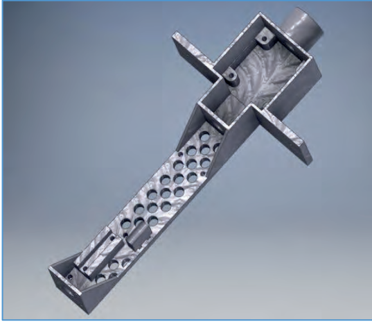
Fig.9: Sistema base para la ubicación y colocación de los sensores de la estación meteorológica, hecho en una impresora en 3D.
