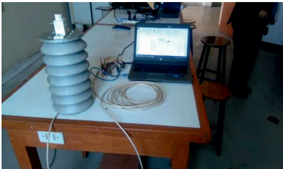
Fig.10: Vista general de la estación meteorológica conectada a la computadora portátil para la transferencia y tratamiento de datos
